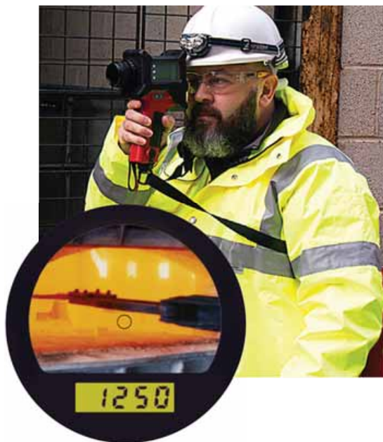
Rysunek 5 Pomiar pirometrem przenośnym LAND Cyclops – weryfikacja temperatury w różnych miejscach (piec, nagrzewnica, wanna, prasa itp.)
