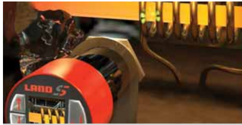
Rysunek 2 Pirometr LAND SPOT+ podczas kontroli procesu nagrzewania indukcyjnego
