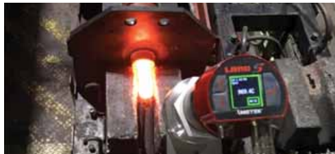
Rysunek 3 Pirometr LAND SPOT+ kontrolujący proces kucia matrycowego
