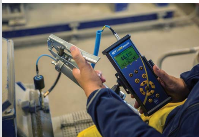
Rysunek 2 Smarowanie w oparciu o pomiar ultradźwięków
