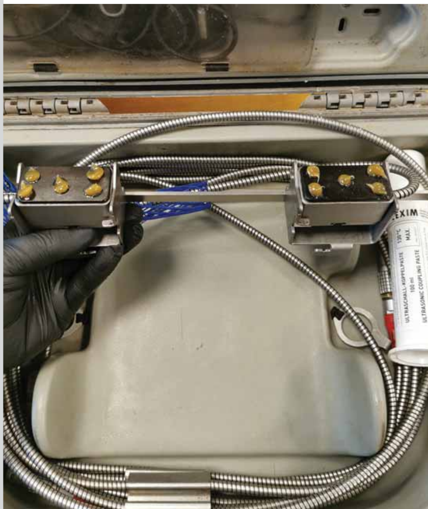
Rysunek 4 Sondy przepływomierza z żelę sprężającym
