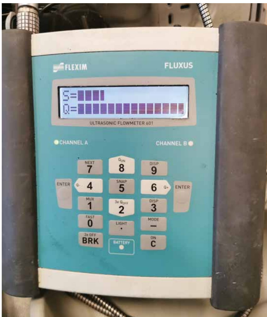
Rysunek 3 Przetwornik przepływomierza Fluxus ze wskazaną siłą i jakością sygnału
