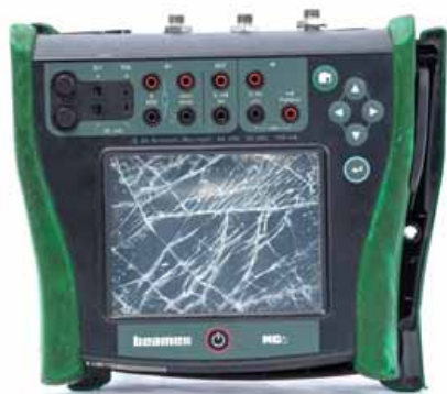
Rysunek 2 Kalibrator ze słuchonym ekranem dotykowym
