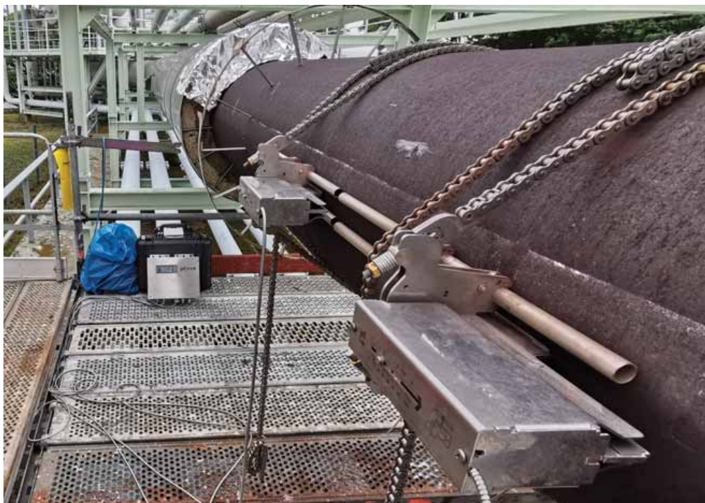
Rysunek 5 Aplikacja z użyciem nakładki wysokotemperaturowej WI
