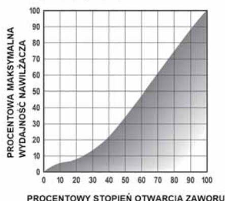
Rysunek 5 Charakterystyka regulacji nawilzacza wykorzystującego grzyb paraboliczny
