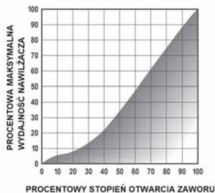
Rysunek 5 Charakterystyka regulacji nawilzacza wykorzystującego grzyb paraboliczny
