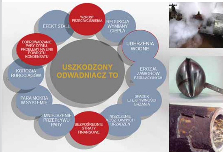
Rysunek 4 Skutki wadliwie działających odwadniaczy
