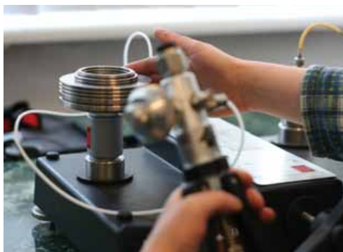
Rysunek 3 Wzorcowanie przy zastosowaniu ciśnieniomierza obciążnikowo-tłokowego
