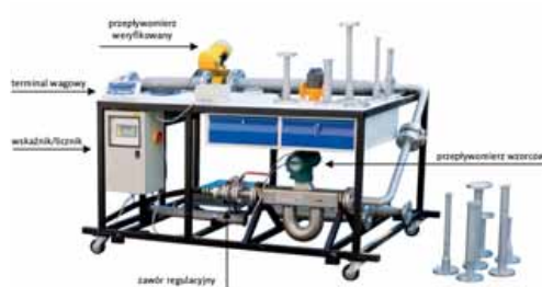
Rysunek 2 Mobilne stanowisko kalibracyjne przepływowomierzy
