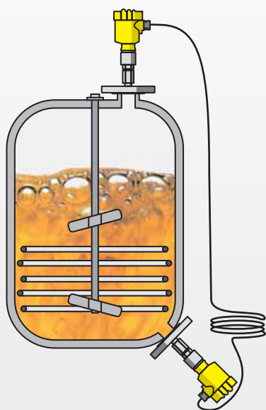
Rysunek 6 Schemat pomiaru różnicy ciśnień
