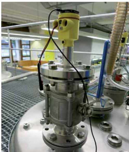
Rysunek 1 Sonda Vegapuls 64 w reaktorze z pianą
