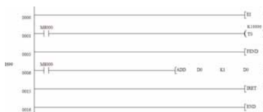
◀ Rysunek 5 Realizacja przykładowego przerwania czasowego
