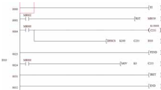
◀ Rysunek 6 Realizacja przykładowego przerwania licznikowego
