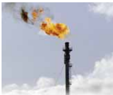
Rys. 1. Spalanie na wylocie szybu, to sposób pozbycia się niepożądanych gazów, zarówno w warunkach normalnej pracy, jak i w stanie zagrożenia. Szeroki zakres natężeń przepływu, czyni to zastosowanie polem konkurencji dla producentów przepływomierzy
