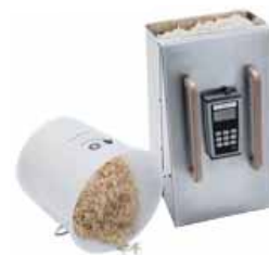
Przenośny miernik wilgotności biomasy FS_3
