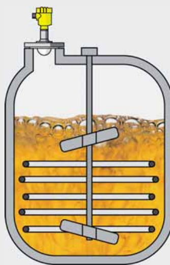
Rysunek 2 Schemat montażu Vegapuls 64
