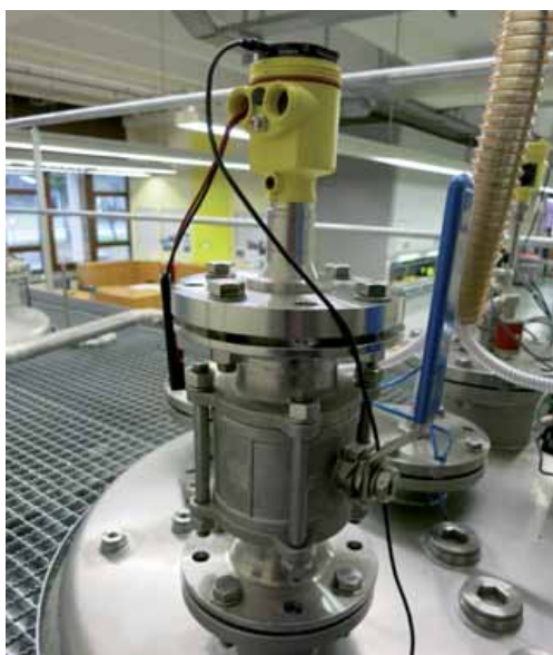
Rysunek 1 Sonda Vegapuls 64 w reaktorze z pianą
