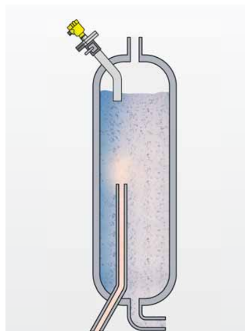
Rysunek 4 Schemat montażu sondy radarowej z rurą pomiarową
