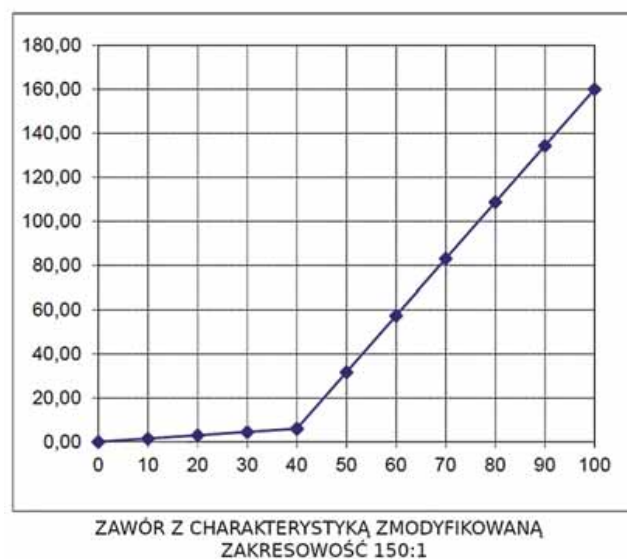
Rysunek 5 Przykład zmodyfikowanej charakterystyki zaworu
