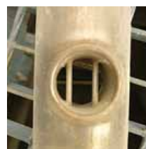
Czujnik pomiarowy po 6 miesięcznej, ciągłej pracy w kanale spalin
