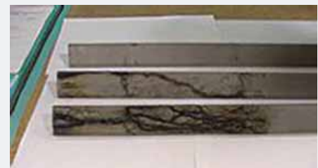
Uszkodzony izolator – drzewienie
