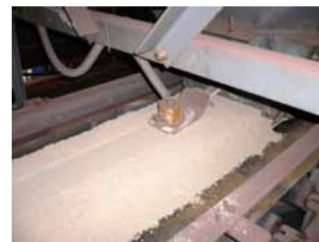
Przykładowy montaż czujnika na taśmociągu przy użyciu płoży
