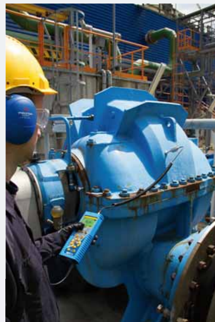
Rejestracja sygnału ultradźwiękowego miernikiem SDT270
