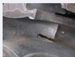
Uszkodzony przez kawitację korpus pompy
