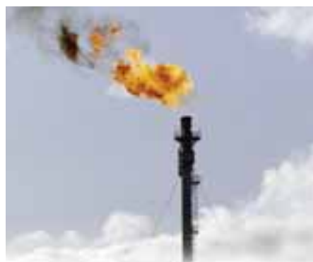
Rys. 1. Spalanie na wylocie szybu, to sposób pozbycia się niepożądanych gazów, zarówno w warunkach normalnej pracy, jak i w stanie zagrożenia. Szeroki zakres natężeń przepływu, czyni to zastosowanie polem konkurencji dla producentów przepływomierzy
