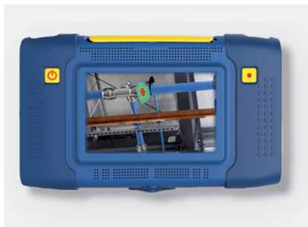
Rysunek 2 Obrazowanie akustyczne wycieku sprężonego powietrza
