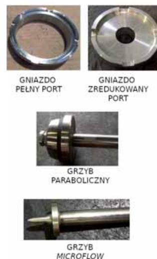
Rysunek 3 Przykład gniazd i grzybów w zaworach regulacyjnych
