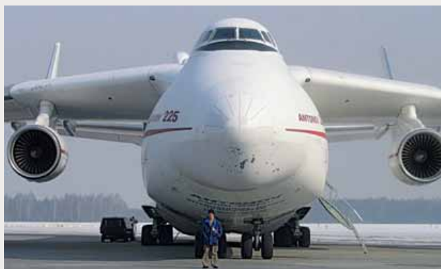
An-225. Wymiary to 84 m długości, 88,4 m rozpiętości skrzydeł i 18,1 m wysokości. Maksymalna masa startowa wynosi 640 ton!
