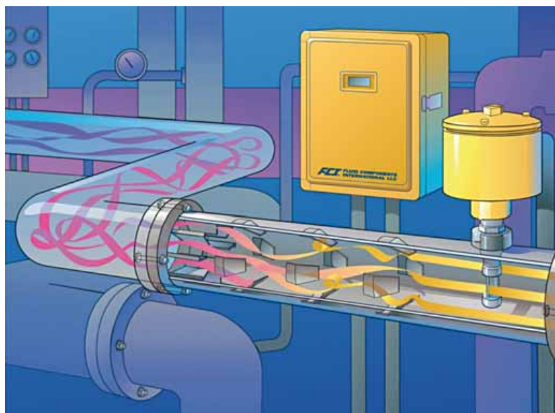
Rysunek 3 Typowa instalacja prostownicy z FCI
