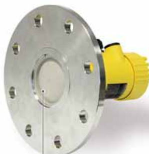
antena soczewkowa 79 GHz DN80, kąt wiązki 4°
