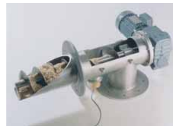
Pomiar trocin za pomocą podajnika ślimakowego montowanego na przesypie
