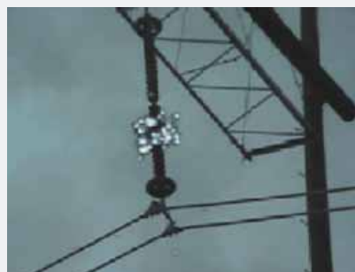
Wyładowanie koronowe – zdjęcie z kamery UV
