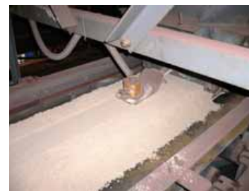
Przykładowy montaż czujnika na taśmociągu przy użyciu płoży
