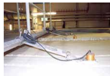
Pomiar gipsu na taśmociągu w trzech punktach
