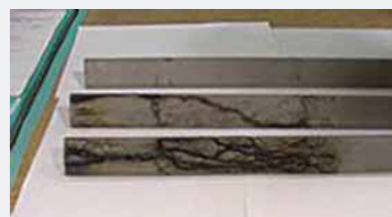
Uszkodzony izolator – drzewienie
