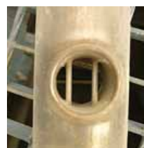
Czujnik pomiarowy po 6 miesięcznej, ciągłej pracy w kanale spalin
